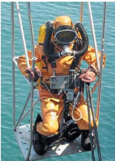
**Снаряжение водолазное глубоководное СВГ-200**
