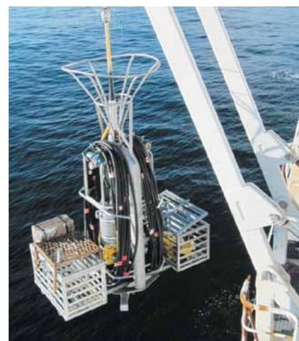
*Подводная гидравлическая станция ПГС-500*
