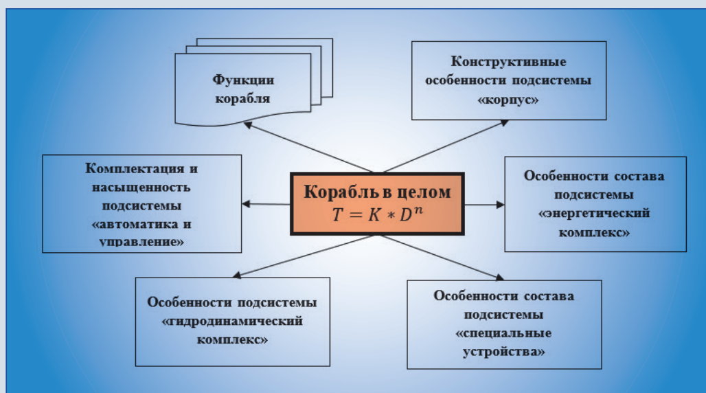
Рис.1. Схематическое изображение параметров сложности и новизны корабля как объекта проектирования при определении трудоёмкости проектно-конструкторских работ («Нормативы...» №299024-Н-91)
